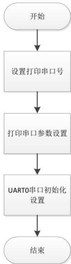
图 4-1 串口使用流程
