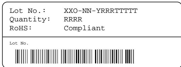
图 20: 卷轴上的标签: XX = 传感器型号 (21 for SHT21), O = 输出方式 (D = Digital, P = PWM, S = SDM), NN = 芯片版本, Y = 年的最后一位, RRR = 卷轴上的传感器数量除以 10 (通常为 200 或 2000)。TTTTT = 追踪代码。
