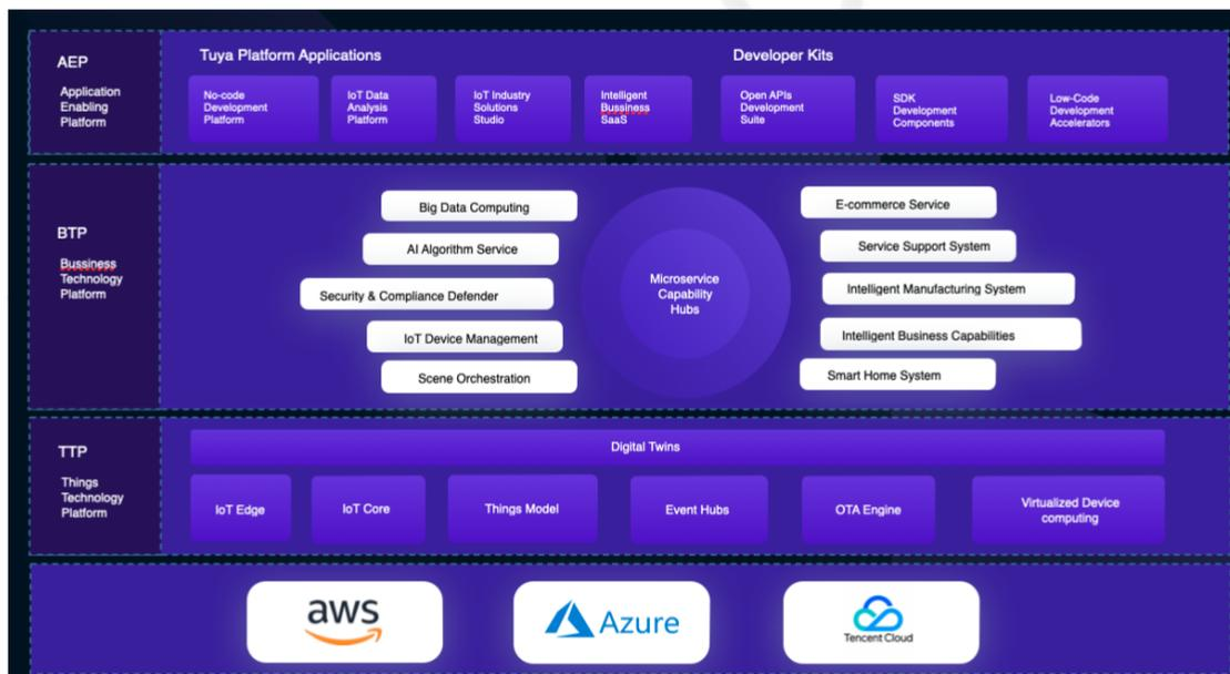
TTP(Things Technology Platform),是一个通用的 IoT 连接&管理平台,基于统一的物模型来抽象终端数据和能力模型,以 IoT Core 为核心完成对设备的连接、授权、认证、和管理的能力,OTA Engine 为设备升级提供统一 OTA 策略和数据分析预测服务,降低设备 OTA 风险,提升设备活跃度,Event Hubs 为上游业务提供灵活的数据中转和事件订阅,丰富上游能力微服务模块化。针对不同的行业需求和设备差异化能力,通过 Virtualized Device Computing 从云端增强硬件能力,通过 IoT Edge 来本地化管理设备接入和场景联动。形成云、边一体的 IoT 数字孪生模型,为上游业务化提供物联底座。
