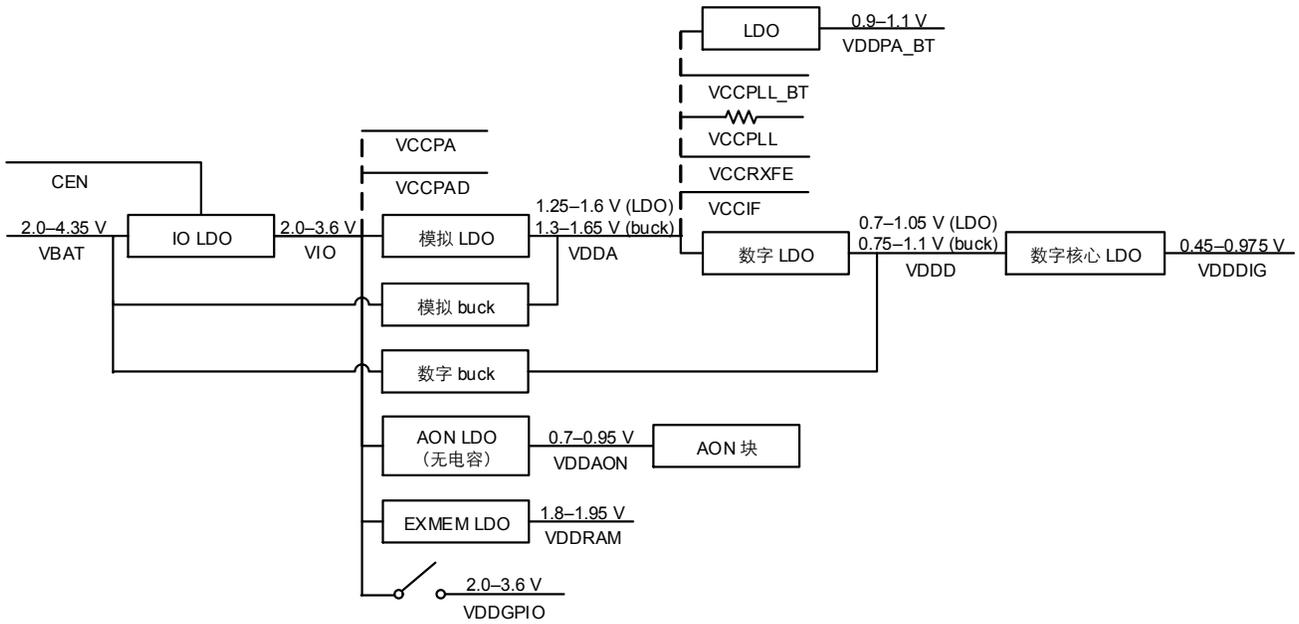
注意：降压转换器和 LDO 稳压器的输出需要合适的旁路电容以降低电源噪声。有关选择旁路电容的详细信息，请参阅硬件原理图。
