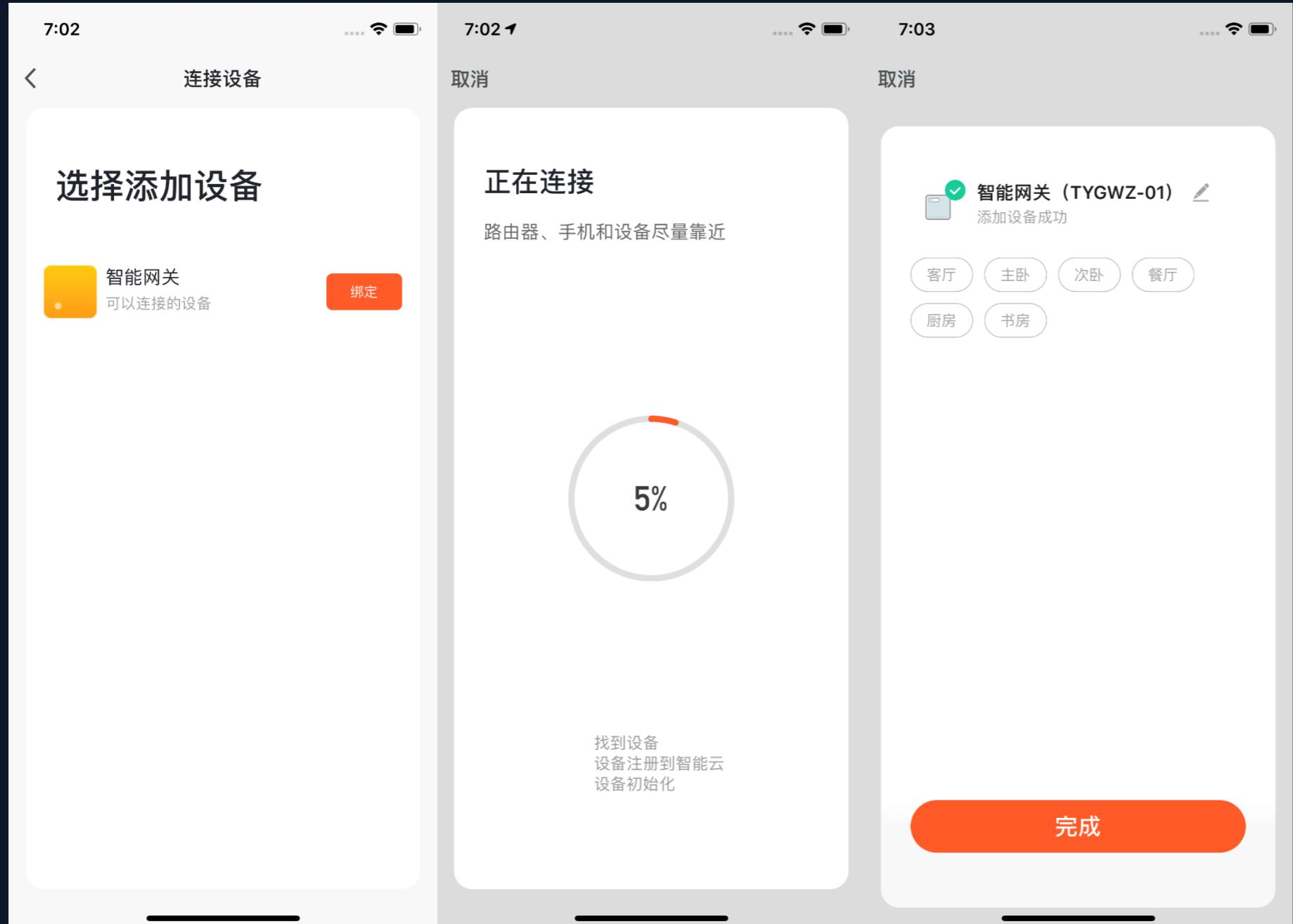
4. 如图所示完成对网关的添加后，下一步即可开始添加与其相连的ZigBee设备。
