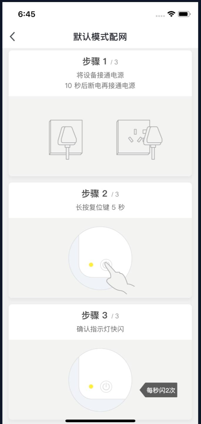
2. 采用 Wi-Fi 快连模式（默认模式）配网，需要先将指示灯设置到快闪状态，请按照图中的3个步骤完成设置。
